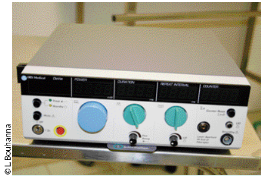
3 Le laser Diovet® produit une longueur d'onde de 810 nm, ce qui le rend sélectif des pigments mélaniques.
